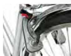
壊されにくい大型のサークル錠にピッキングに強いディンプルキー採用。
